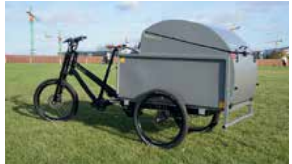
Das regensichere Alubox-Fahrrad von Radkutsche (Mössingen) schafft Ladungen über 100 Kilogramm.
