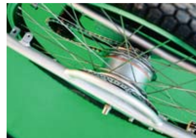
Beim Speedliner gibt es kein Differential. Die Kraft kommt über eine Primärkette und eine Achse zu dieser kurzen Kette.
